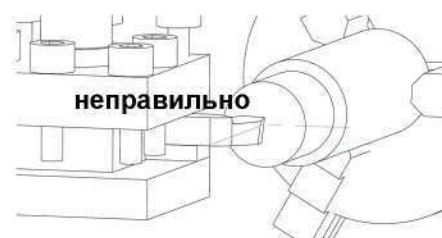
Рис. 3-4: Установка токарного резца
