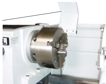
Abb.1-4: Защита токарного патрона
