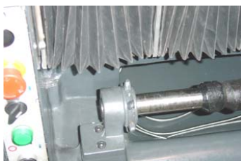
Механическое отключение продольной подачи продольной каретки суппорта
