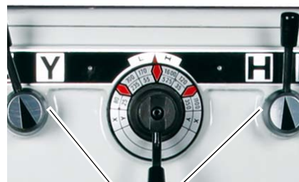
Рукоятки выбора диапазона установки числа оборотов
