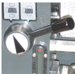
Пусковая рукоятка нарезания резьбы
