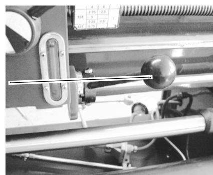
Abb.4-3: Рукоятка переключения вращения шпинделя
