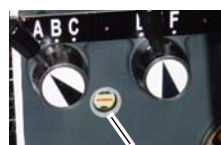
Маслоуказатель коробки передач
