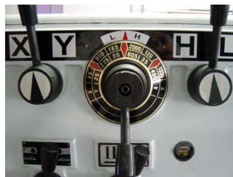
Abb.4-2: Установка числа оборотов
